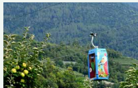
Foto B - Funicolare dedicata al trasporto di frutta (evita 5000 viaggi di camion) dai meleti della Val di Non (irrigati a goccia) alle celle ipogee (frigoconservazione naturale che permette un risparmio energetico del 30%) in una cava dismessa (evita il consumo di suolo). Alimentato da energie rinnovabili (fotovoltaico/idroelettrico) e sfrutta inoltre il peso delle mele in discesa per contribuire a produrre energia.
